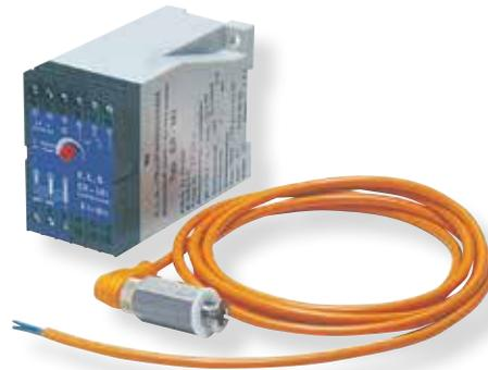
Bei einem Ausfall der Membran strömt das geförderte Medium in die Luftkammer und löst ein Signal am Sensor aus. Der Sensor sendet daraufhin ein elektrisches Signal an das Überwachungsgerät, das eine Auswertung des Signals vornimmt. Der Ausgang des Überwachungsgerätes kann dann zur Abschaltung der Pumpe genutzt werden.
