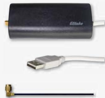
**Funk-Antennen-Modul (Empfänger und Sender) mit USB-Schnittstelle zum Betrieb an einem Server FVS-Safe oder einem PC mit der Funk-Visualisierungs- und Steuerungssoftware FVS-Home.**
