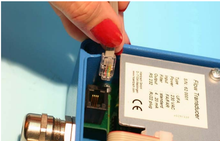
Abb. 1: Anschluss PC-Anschlussleitung mit RJ22 Stecker bei geöffnetem Gehäusedeckel
