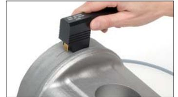
Risstiefenmessung an einem schräg verlaufenden Riss nach der Winkelbestimmung
