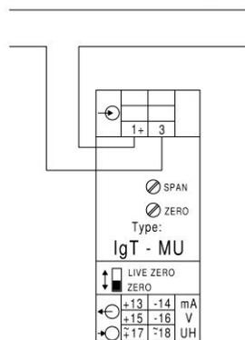
Bei Geräten mit Frequenzmodul entfallen weitere Ausgänge. An den Klemmen +13 und -14 steht der Frequenzgang zur Verfügung.
